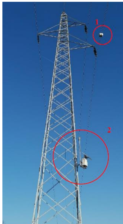
Slika 2.1.7. Senzorska jedinica DLR sistema, [25]
